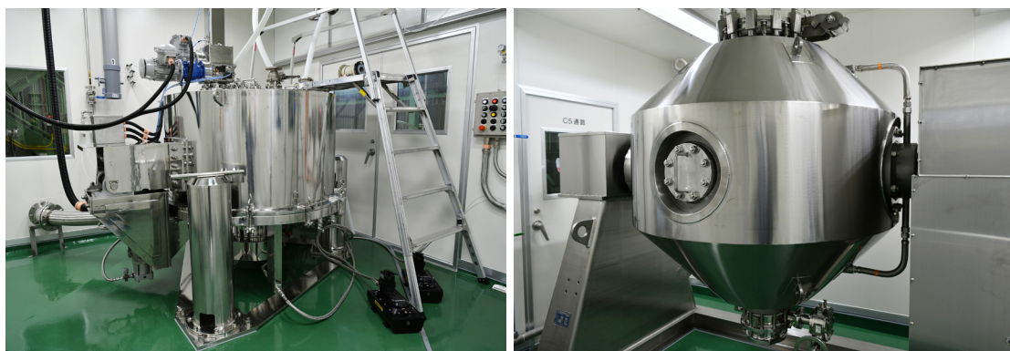
原薬の原料となる化学物質の純度を高めるための遠心分離機。
